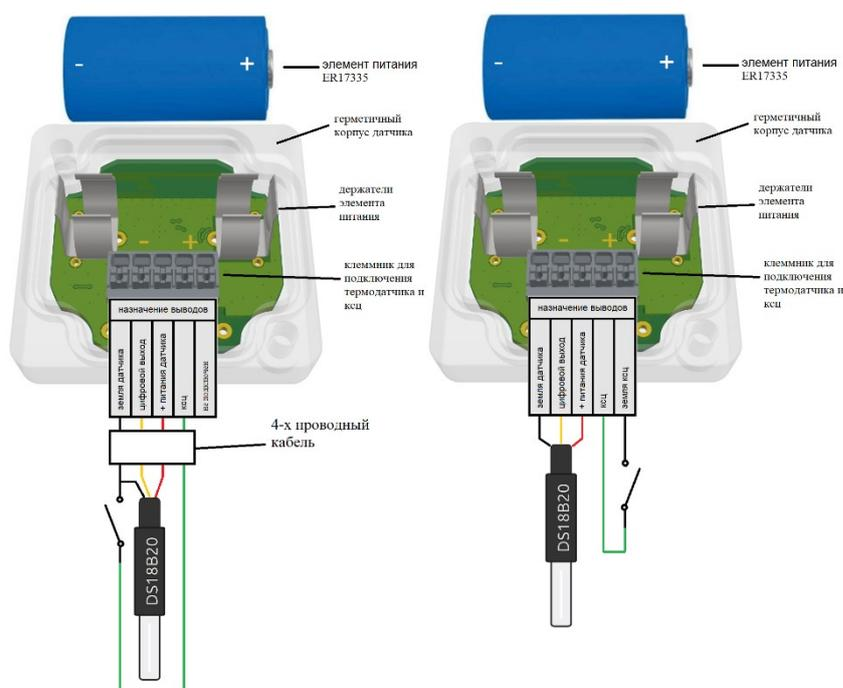
*Рисунок 3 - Элементы устройства и схема подключения*
