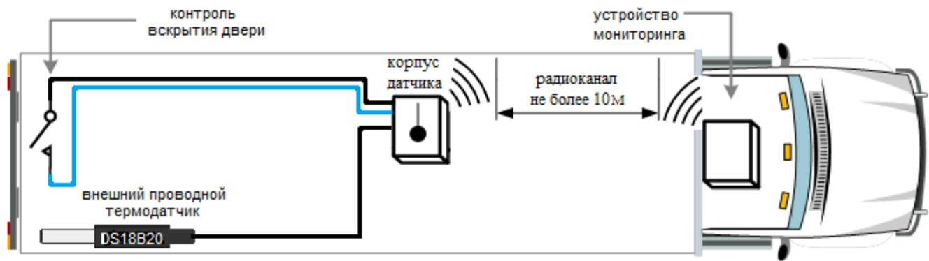
Рисунок 4 - Пример установки контроля двери и температуры
