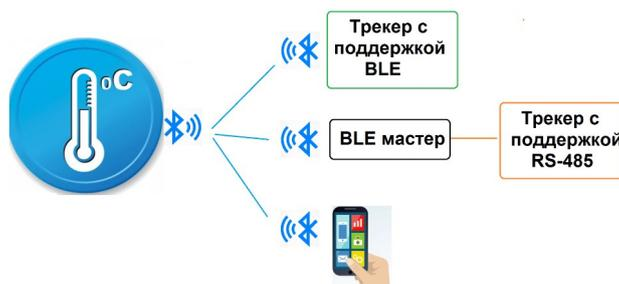
*Рисунок 2 - Варианты использования датчика с внешними устройствами*
