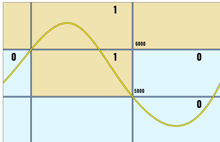
Рисунок 2.14 Преобразование аналогового сигнала в дискретный
